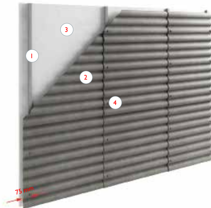
Joonis 52. Plaatide horisontaalne paigaldamine fassaadidele või seintele, pikisuunalise ülekattega ühe laine ulatuses ja ristsuunalise ülekattega 150 mm: 1: maapinnaga risti asetsevad tugilattid; 2: EuroFala plaadid, paigaldatud pikisuunalise ülekattega ühe laine ulatuses ja ristsuunalise ülekattega 150 mm; 3: hoone olemasolev sein; 4: plaatide kinnituspunkti asetused: B59-plaadid: 2. ja 6. laine harjal, B65-plaadid: 2. ja 5. laine harjal.
