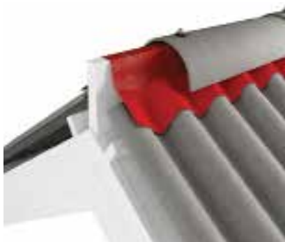
Joonis 7. Harjadetaili ja tihendusribaga kaetud katusehari: tuulutusavade pindala katuseharja 1 jooksva meetri kohta: plaadid B59 – 150 cm 2 , plaadid B65 – 255 cm 2 iga katuseviilu kohta.
