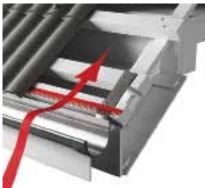
Joonis 5. Katuseräästas: tuulutusavade pindala 1 jooksva meetri kohta: plaadid B59 – 120 cm 2 ; plaadid B65 – 200 cm 2 .
