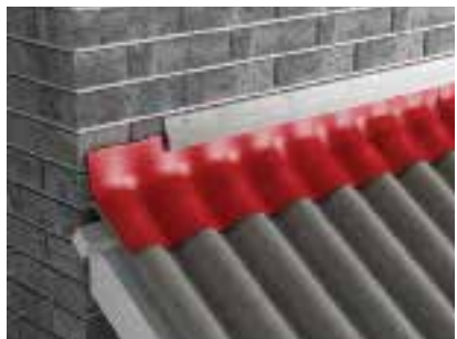
Joonis 44. Katuseviilu ja hoone seina ühenduskoha ehitamine.
