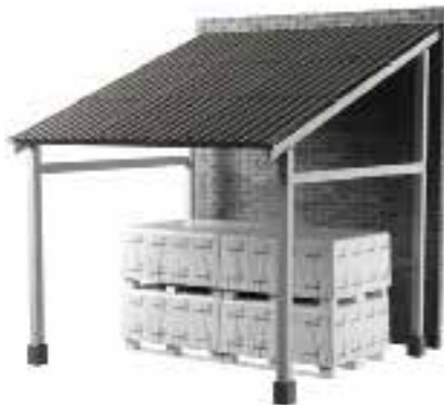
Tooteid tuleb hoida kaetud hoiukohtades. Ühte vinnat lubatakse ülestikku panna ainult kaks alust.
