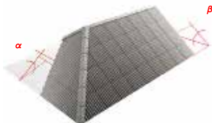
Joonis 37. Kahe lõikuva katuseviilu kaldenurgad
