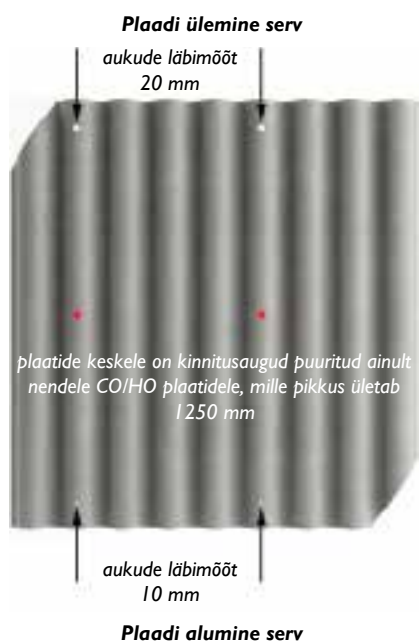
Joonis 22. Plaat EuroFala B59 CO/HO: viltu lõigatud nurgad ja kinnitusaugud. EuroFala B65 CO/HO plaatidel on kinnitusaugud puuritud 2. ja 5. laine harjale.
