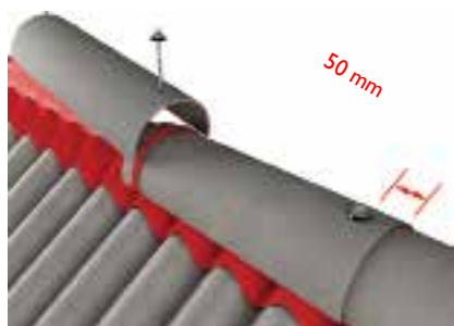
Joonis 35. Poolsilindri kujulise harjadetaili paigaldamine.
