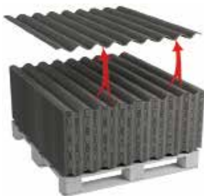
Iga plaati aluselt võttes tuleb see üles tõsta. Mingil juhul ei ole lubatud plaate vinnast maha tõmmata ega lükata. Plaatide tõmbamisel rikume ja kahjustame alumiste plaatide värvitud pinda.
