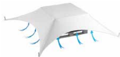
Seejärel tuleb tooted paigutada kuivale ja siledale alusele, vinnaga katta tendiga, mis kaitseb sademete eest ning tagab õhu vaba tsirkulatsiooni plaatide ümber.
