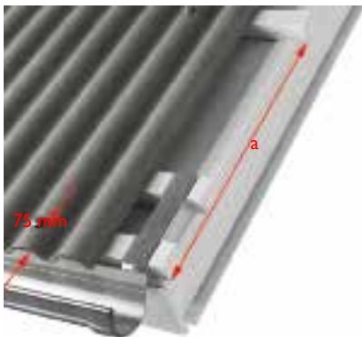
Joonis 2. Katuseräästa juures on kaugus EUROFALA plaadi servast kuni esimese kinnituspunkti vähemalt 75 mm.
